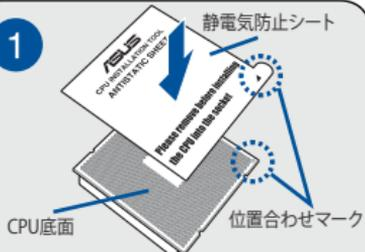
手の汚れ、静電気などによる故障を防止するため、CPU底面に静電気防止シートを貼り付けます。
