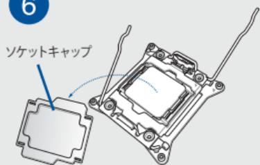
ロードプレートとロードレバーを押し下げCPUを固定し、ソケットキャップを取り外します。
