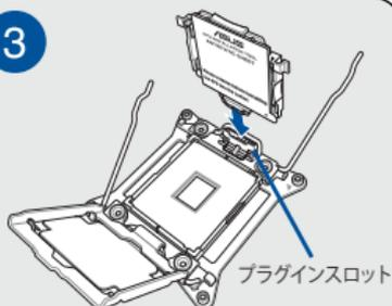
CPUソケットのロードレバーを押し上げ、専用プラグインスロットにCPUインストールツールの突起部を奥までしっかり挿入します。
