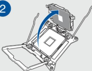
ロードレバーを押し上げると、同時にCPUが押し上げられます。
