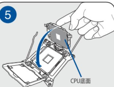
CPUインストールツールが所定の位置に正しく取り付けられていることを確認し、CPUをゆっくりと倒しソケットに収めます。
