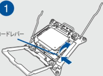
ロードレバーのロックを外しロードプレートを開いた後、ゆっくりロードレバーを押し上げます。
