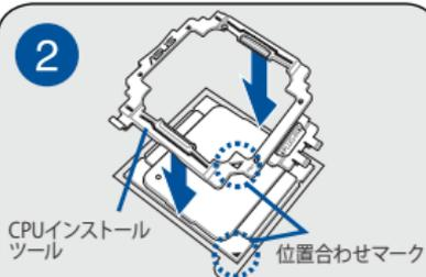
CPU表面とCPUインストールツールの位置合わせマークが同じ方向にあることを確認し、CPUインストールツールを取り付けます。
