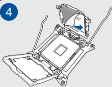
CPU底面に貼り付けた静電気防止シートを剥がします。
